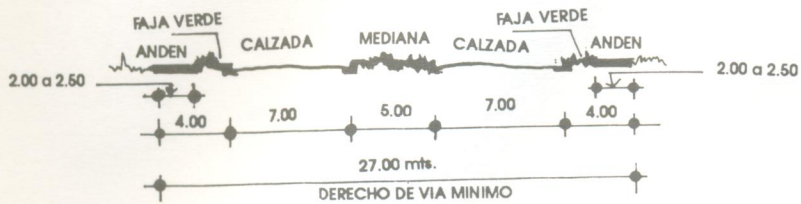
SECCION TIPICA DE COLECTORA PRIMARIA ESCALA : ..... 1: 33 1/3
