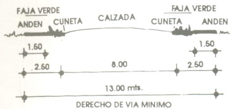
SECCION TIPICA DE CALLEJON COMERCIAL ESCALA : ..... 1: 200
